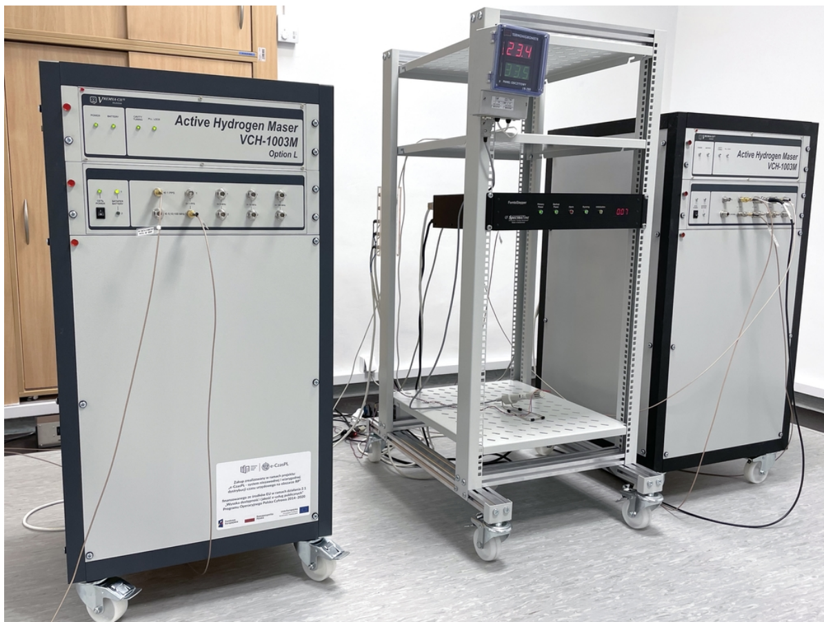
Rys. 1. Masery wodorowe wchodzące w skład Państwowego Wzorca Czasu i Częstotliwości.
