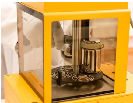
Wzorzec masy 1 kg wstawiany do komparatora
