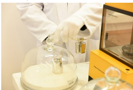
Wzorzec masy 1 kg wstawiany do komparatora
