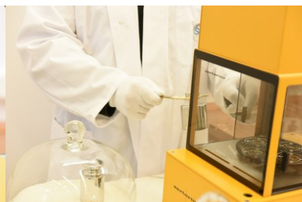
Wzorzec masy 1 kg wstawiany do komparatora
