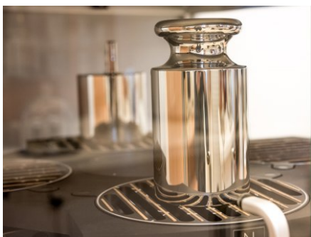
Wzorzec masy 10 kg w komparatorze
