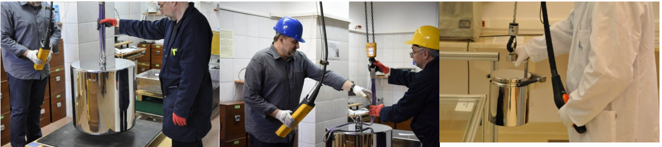
Załadunek wzorca 50 kg do komparatora
