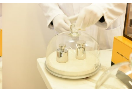
Wzorzec masy 1 kg wstawiany do komparatora
