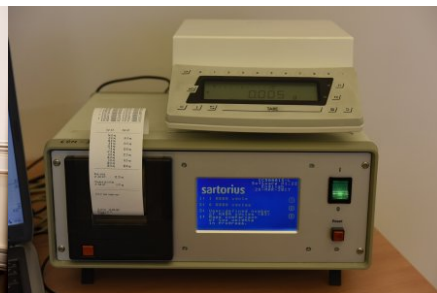
Miernik wagowy i sterownik do komparatora
