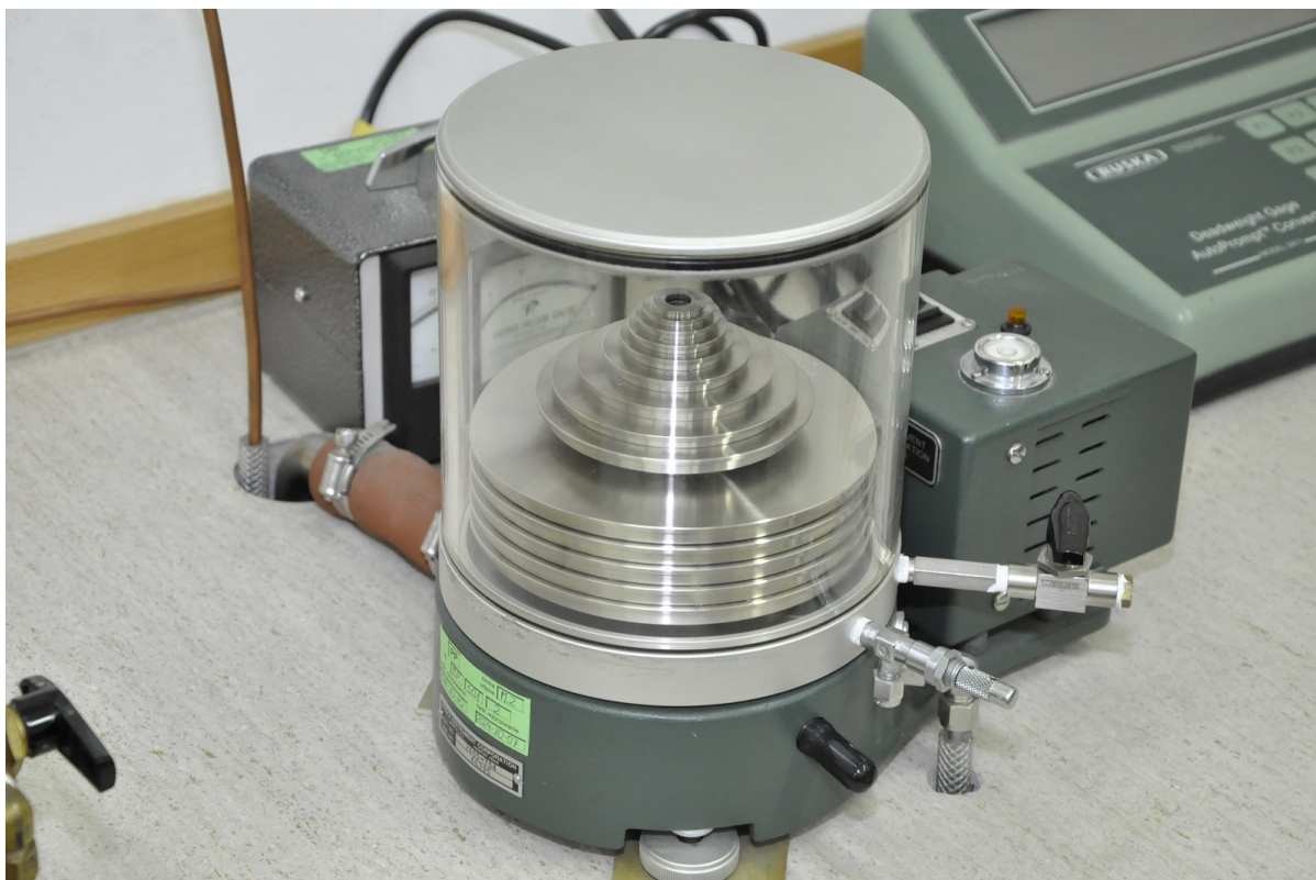
Podstawa z zespołem pomiarowym i obciążnikami, część stanowiska wzorcowego o zakresie pomiarowym do 7 MPa.
