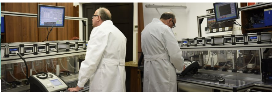
Stanowisko do wzorcowania analizatorów wydechu metodą wilgotnych wzorców etanolowych - przygotowanie do wzorcowania analizatora wydechu
