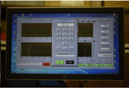
Oprogramowanie stanowiska do wzorcowania analizatorów wydechu metodą wilgotnych wzorców etanolowych – aplikacja w środowisku LabView
