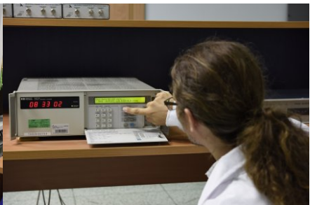
Przy zegarze cezowym - atomowym wzorcu czasu i częstotliwości
