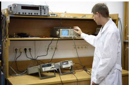
Praca przy stanowisku do wzorcowania przyrządów z dziedziny czasu i częstotliwości
