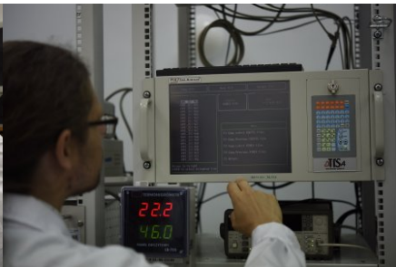
System do transferu czasu metodą obserwacji satelitów systemów nawigacyjnych (GPS, Glonass)
