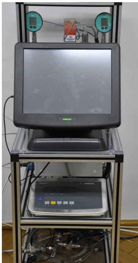
Wyposażenie do wytwarzania suchych wzorców etanolu w azocie na stanowisku do wytwarzania mieszanin gazowych metodą grawimetryczną
