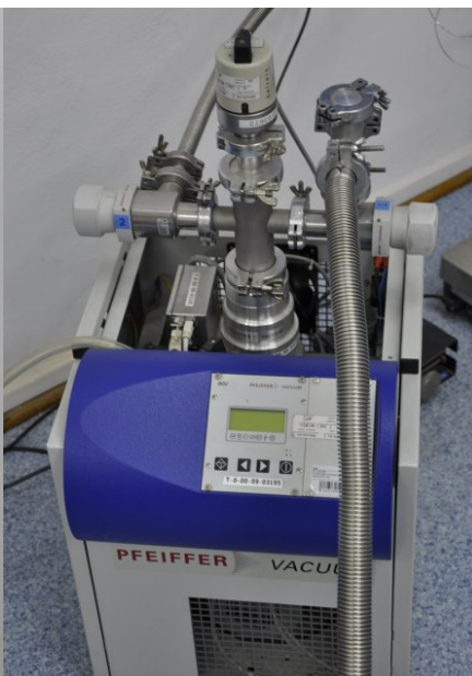
Pompa turbomolekularna na stanowisku do wytwarzania mieszanin gazowych metodą grawimetryczną
