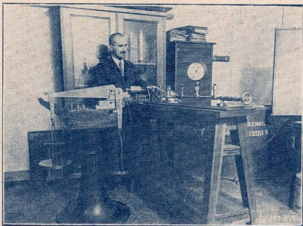
Rys. 8. Przyrząd Stückrath'a do sprawdzania manometrów.
