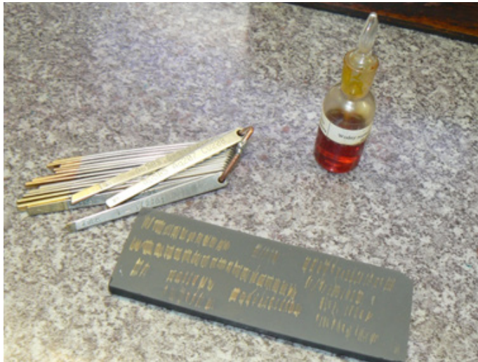
Wymagane elementy zestawu do badania metodą przybliżoną na kamieniu probierczym fot. arch. OUP Kraków
