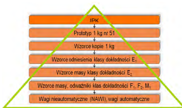
Rys. 4. Uproszczony schemat hierarchicznego układu sprawdzeń w GUM
