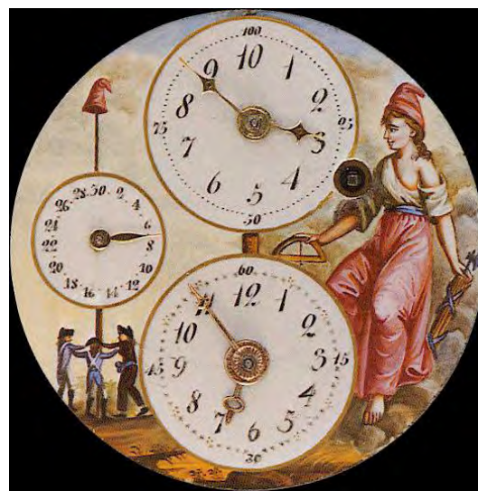
Zegar z czasów Rewolucji Francuskiej. Pokazuje czas „zwyczajny” i „dziesiętny”. Fascynacja układem dziesiętnym skonkretyzowała się m.in. w postulacie, aby czas mierzono także w jednostkach dziesiętnych.
