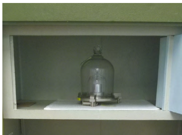
Rys. 3. Sposób przechowywania prototypu nr 51 w GUM fot.: Laboratorium Masy GUM
