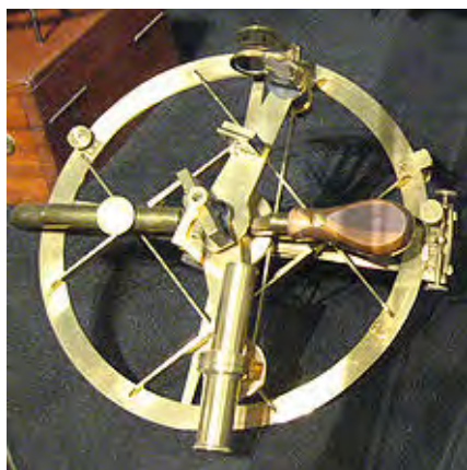
Instrument repetycyjny (koło powtarzające Bordy lub inaczej koło Bordy) – przyrządu takiego użyto do pomiarów południka.
