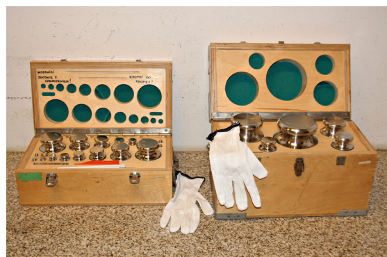
Wzorce masy ze stali nierdzewnej niemagnetycznej stosowane do sprawdzania wag kl. III o obciążeniu max. do 15 kg fot. arch. własne
