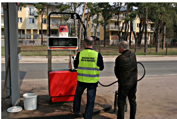
Nalewanie paliwa do kolby pomiarowej w czasie legalizacji odmierzacza oraz zestaw kolb pomiarowych o pojemnościach od 5 dm 3 do 500 dm 3 do legalizacji różnych typów odmierzaczy i instalacji pomiarowych
