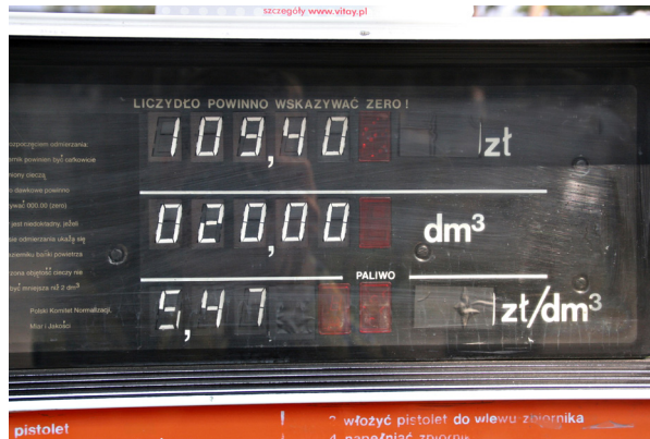
Porównanie ilości wydanego paliwa z wyświetlacza odmierzacza z ilością, która została odmierzona w kolbie pomiarowej fot. arch. własne
