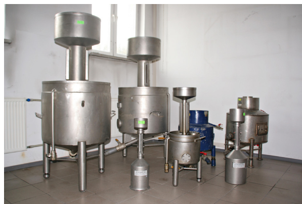
Nalewanie paliwa do kolby pomiarowej w czasie legalizacji odmierzacza oraz zestaw kolb pomiarowych o pojemnościach od 5 dm 3 do 500 dm 3 do legalizacji różnych typów odmierzaczy i instalacji pomiarowych
