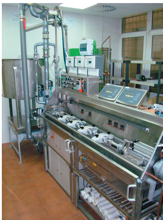
Stanowisko do sprawdzania wodomierzy, przepływomierzy i przetworników przepływu do ciepłomierzy
