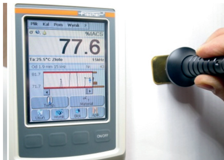
Rys. 7. Pomiar przewodności elektrycznej sztabki dla złota próby 0,999 Au
