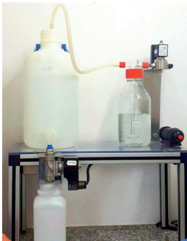
Rys. 4 Układ dozowania CRM do opakowań jednostkowych
