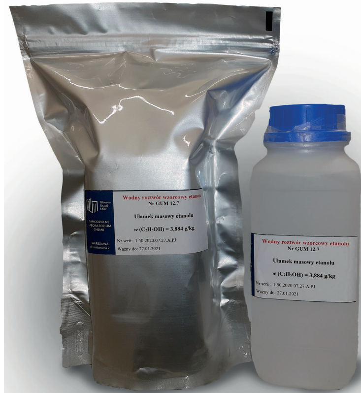
Rys. 5. Butelka z CRM i butelka umieszczona w torebce strunowej
