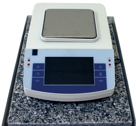
■ Rys. 6. Waga elektroniczna na stanowisku pomiarowym
