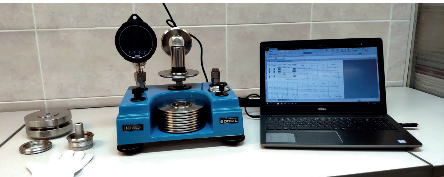
■ Rys. 1. Stanowisko do wzorcowania ciśnieniomierzy w zakresie od 1 000 mbar do 2 000 mbar
