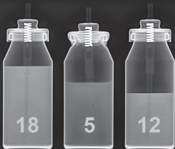
Rys. 9. Przykładowe zdjęcie pojemnika aerozolowego z dwoma pojemnikami wzorcowymi
