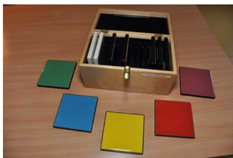
Rys. 12. Zestaw wzorców losy Ceramic Colour Standards – firmy CERAM
