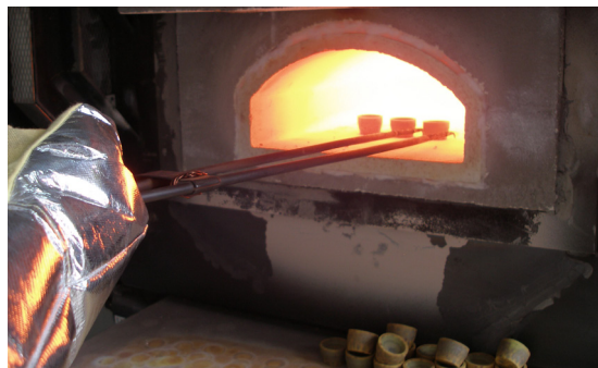
Fot. 4. Wnętrze pieca kupelacyjnego z kupelkami
