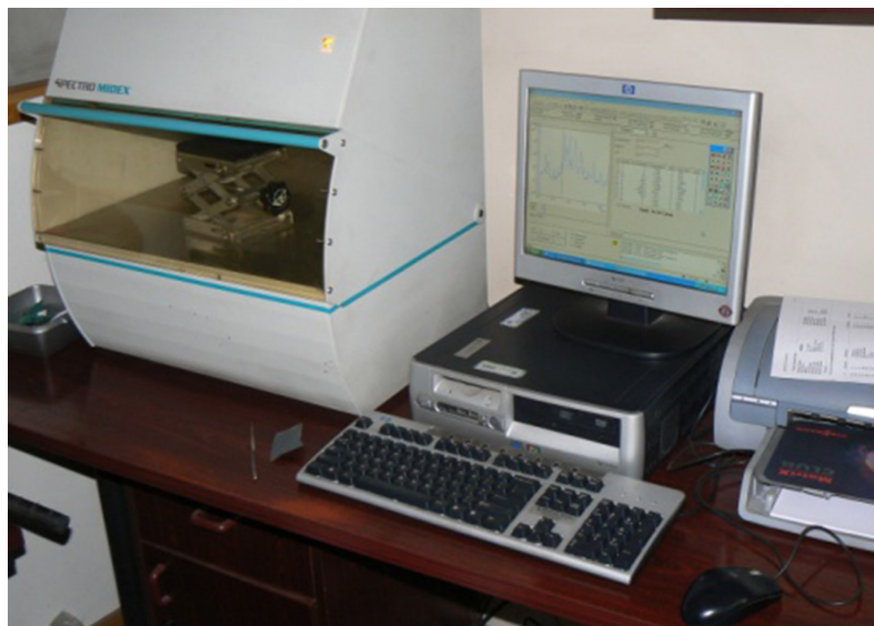
Fot. 2. Stanowisko do badania składu stopów metodą fluorescencji rentgenowskiej fot. arch. własne
