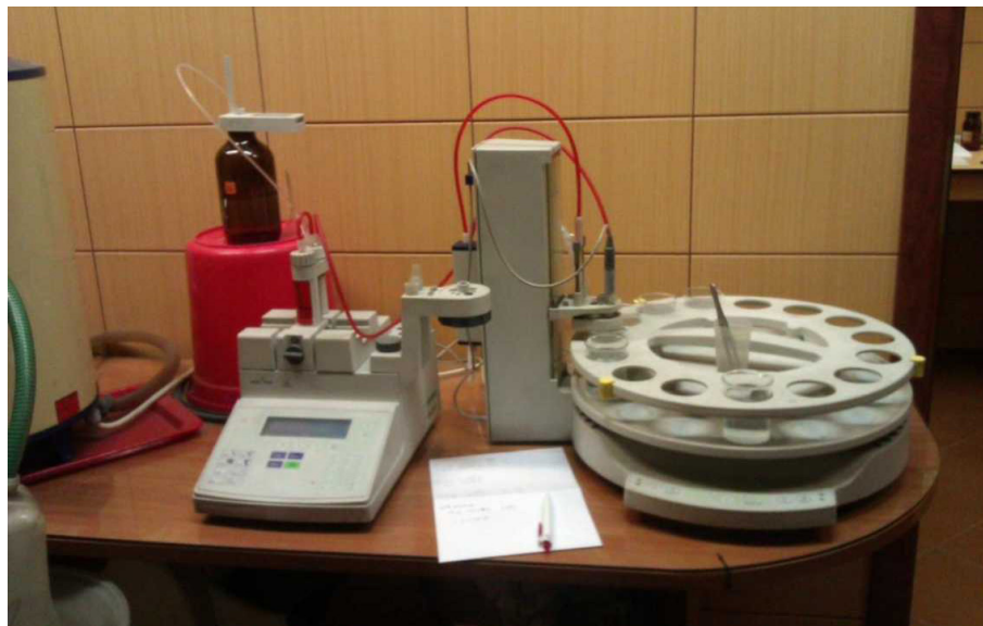
Fot. 5. Stanowisko do badania stopów srebra metodą potencjometryczną
