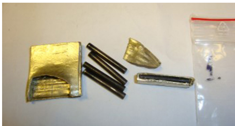
Fot. 1. Przykłady wypełnienia sztabki złotej wolframem
