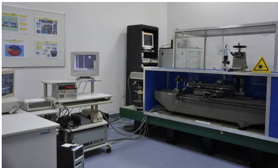
Komparator interferencyjny do wzorcowania wzorców kreskowych
