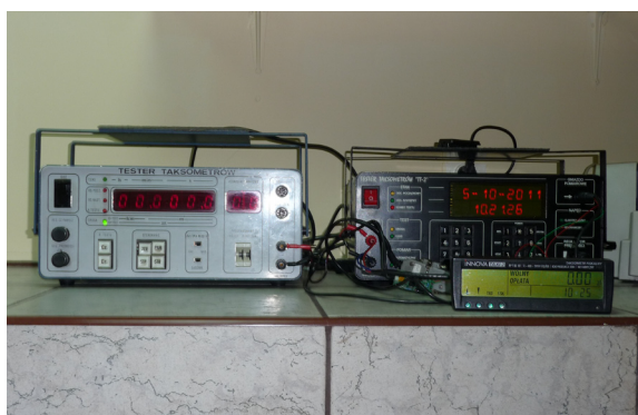
Dwie generacje stanowisk kontrolnych do legalizacji taksometrów – po lewej tester TT-1, po prawej tester TT-2 umożliwiające sprawdzanie taksometrów w cyklu automatycznym
