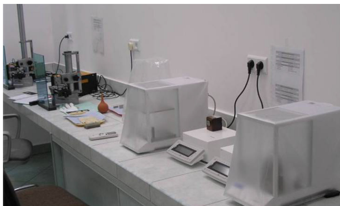
Zestaw wag analitycznych stosowanych do wzorcowania wzorców masy kl. F_1 i F_2
