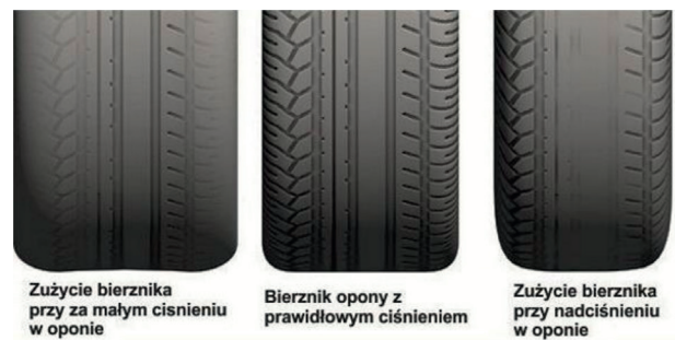
Rys. 4. Wpływ niskiego ciśnienia na zużycie opony [8, 9]
