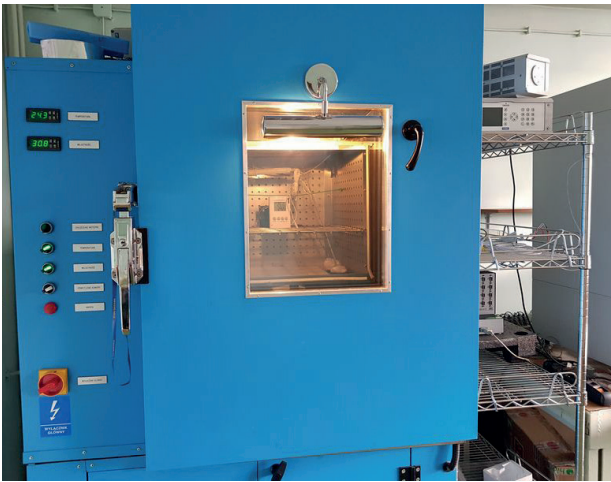
Widok komory klimatycznej w Pracowni Pomiarów Ciśnienia, Temperatury i Wilgotności w OUM w Łodzi
