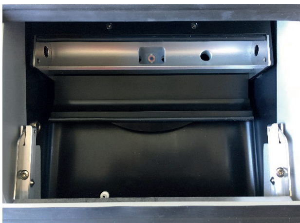
Rys. 2. Komora pomiarowa polarymetru z bezprzewodową automatyczną identyfikacją kwarcowych płytek kontrolnych oraz cel pomiarowych produkcji Anton Paar
