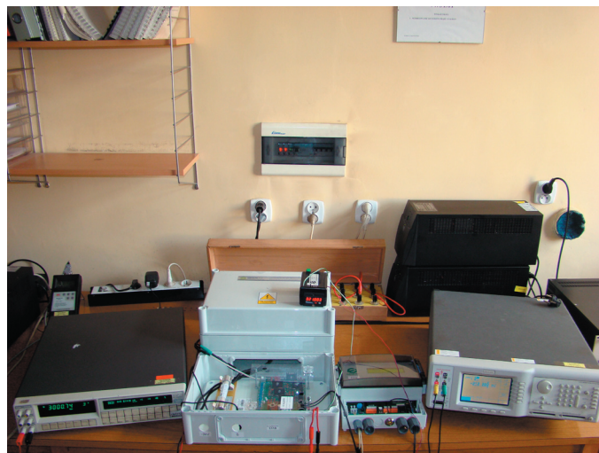
Stanowisko do sprawdzania liczników i boczników prądu stałego
