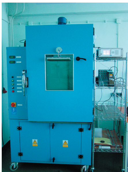
Stanowisko do wzorcowania termometrów i termohigrometrów
