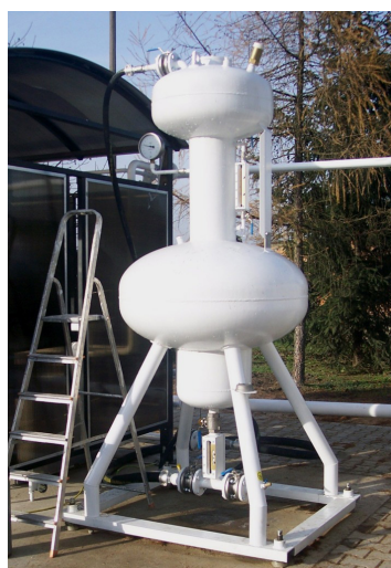
Rys. 4. Kolba metalowa II rzędu o pojemności nominalnej 500 \text{ dm}^3 (ObUM Leszno)
