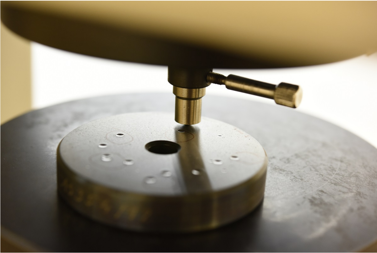
Wzorcowanie wzorca twardości Brinella - faza obciążania
