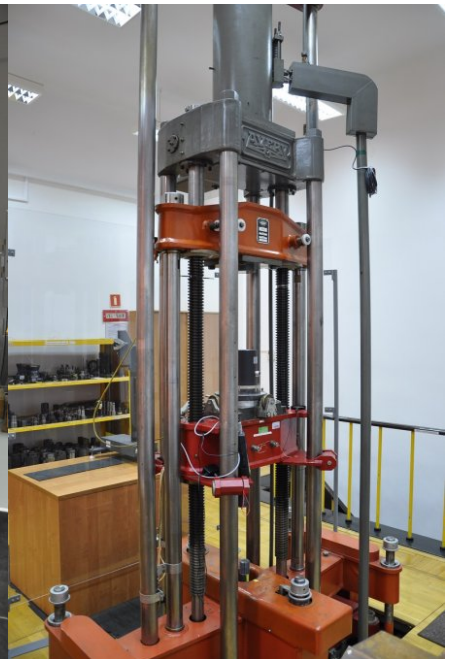
Maszyna obciążnikowa stanowiska wzorcowego siły do 500 kN
