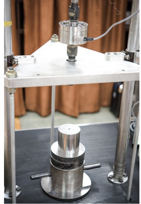
Fragment maszyny obciążnikowej stanowiska wzorcowego siły do 55 kN
